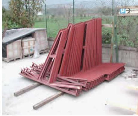
Cavallette con angolo di 90° tra il corrente inferiore (piede) ed il montante
