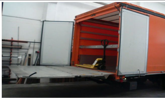
rampa elettroidraulica, comunemente chiamata sponda idraulica
