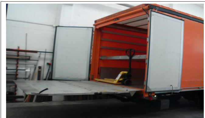
rampa elettroidraulica, comunemente chiamata sponda idraulica
